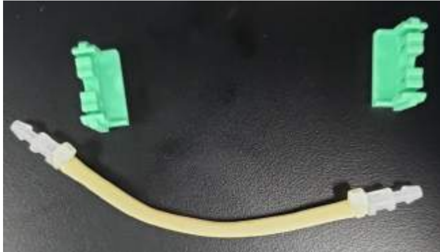
Şek. 5-21 Peristaltik pompa tüpünü değiştirin
