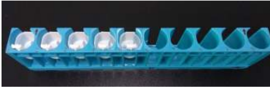
Şekil 4-36 QC şişe kılıflarının yerleştirilmesi
