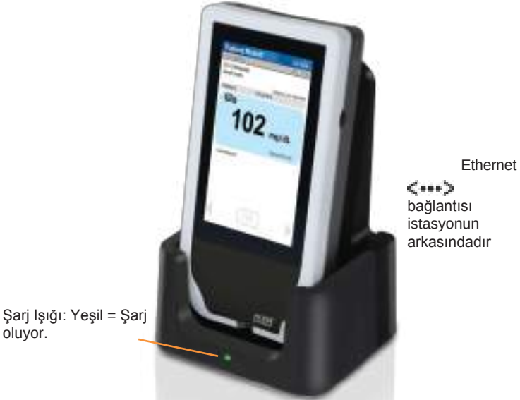
Şekil 4.1 Bağlantı/Şarj İstasyonundaki Ölçüm Cihazı
