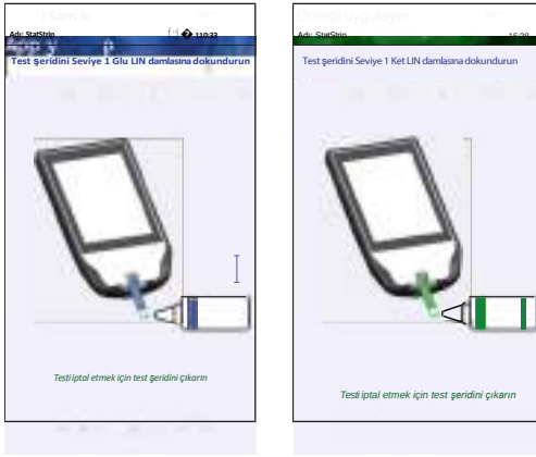
Şekil 5.4 Test Şeridine Numune (Doğrusallık Çözeltilisi) Uygulayın Ekranı
