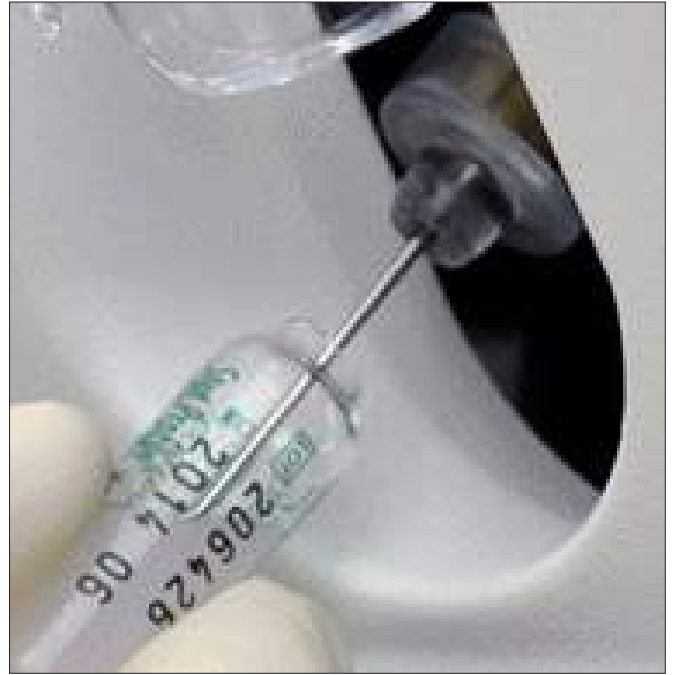
Şekil 3.13 Harici Kalite Kontrol Ampulü Prob Üzerine Yerleştirildi
