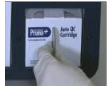
Őekil 5.7 Otomatik Kalite Kontrol Kartuřunu ıkarma
