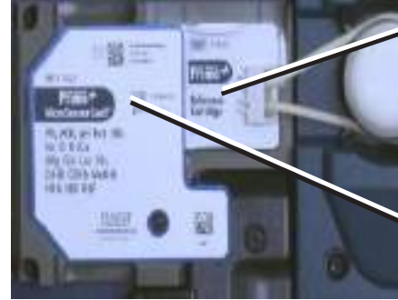
Şekil 5.8 Referans Kartuşu, ABG Mikro Sensör Kartının Arkasına Yerleştirilmiştir
