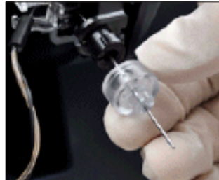
řekil 5.3 Kalibrasyon Kartuřunu ve Kapiler Adaptörü Çıkarma
