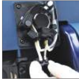
Şekil 6.4 Pompa Manifoldunun Bağlantısını Kesme
