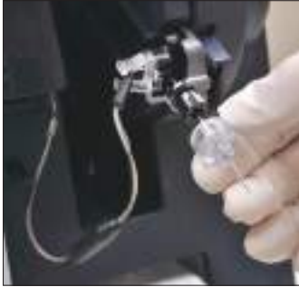
řekil 6.6 Kapiler Adaptörü Sökme
