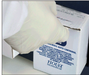
řekil 5.5 Otomatik Kalite Kontrol Kartuşunu Çıkarma
