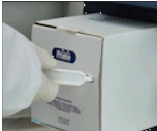
řekil 5.3 Kalibrasyon Kartuřunu ve Kapiler Adaptörü Çıkarma
