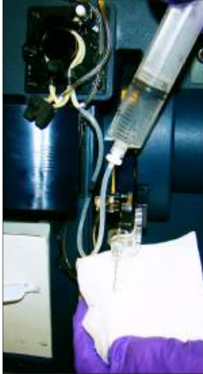
Şekil 7.5 Akış Yolunun Gazlı Bezle Temizlenmesi
